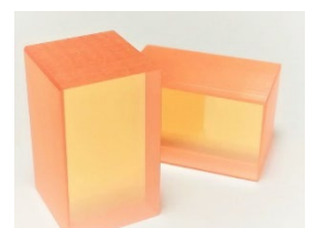
红外激光晶体 适用波长: 0.47-18 \mu m
