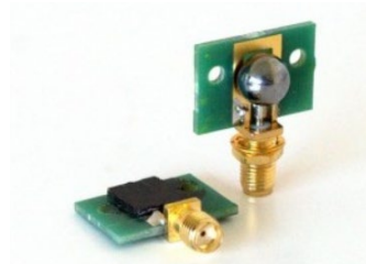
TeraSense 超快太赫兹探测器 响应时间: 150ps
