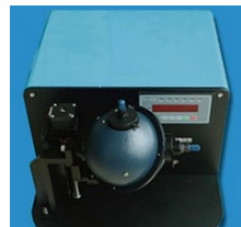
量子效率测量系统 波长: 380-1100nm
