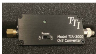
TIA-3000 光电转换器 30kHz-10GHz, 0.8A/W 900~1700nm, AC 耦合
