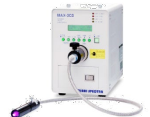
Asahi 氙灯光源 100W, 300W, 400W 输出波长 250~1050nm
