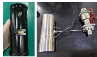
MCT 红外探测器 光敏面: 1.0mm \times 1.0mm 波长: 2-16 \mu\text{m}
